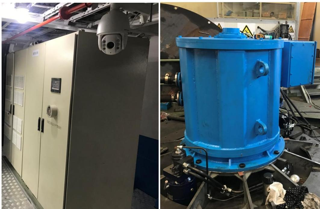
图6 “江苏路渡3012轮”超级电容和推进电机实景照片
