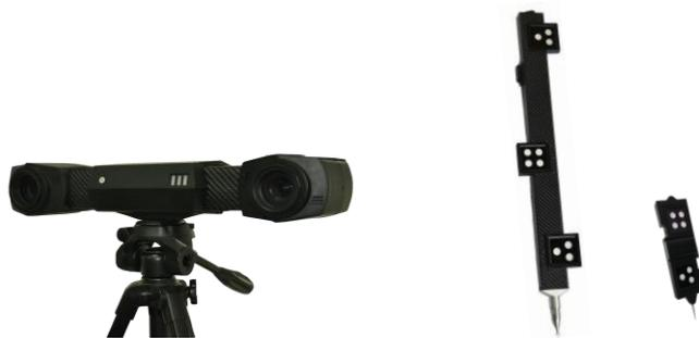
图 3 阳明双目测量主机及标靶
