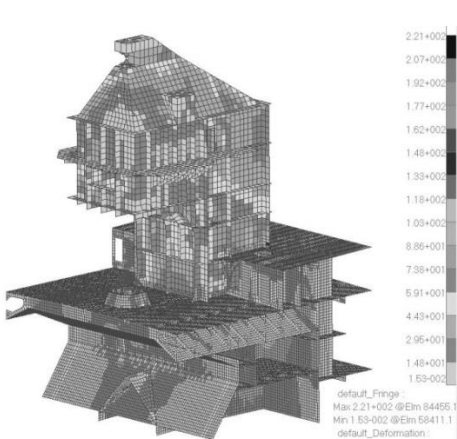
图 5 工况 1 的最大应力效果图
