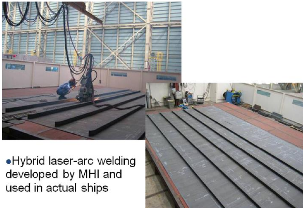
图 13 日本三菱造船厂在船体焊接中的激光-电弧复合焊
