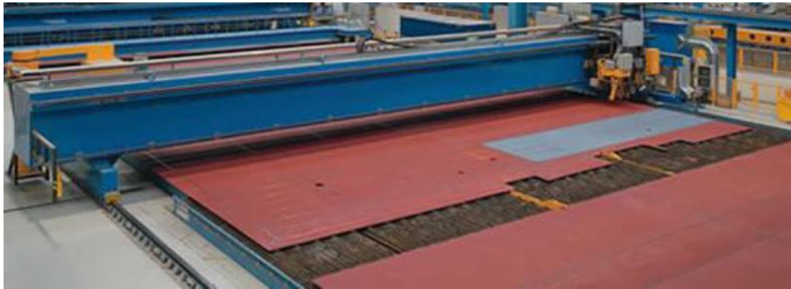
(a)激光用于板材的拼接
