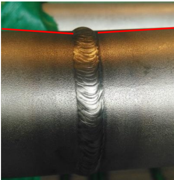
图 7 焊后不锈钢管子变形
