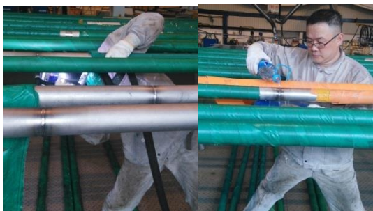
图8 氩弧焊加热+水冷管子
