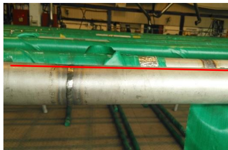
图9 矫正后不锈钢状态
