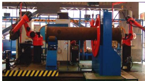
图9 船舶大型直管-法兰机器人柔性焊接系统
