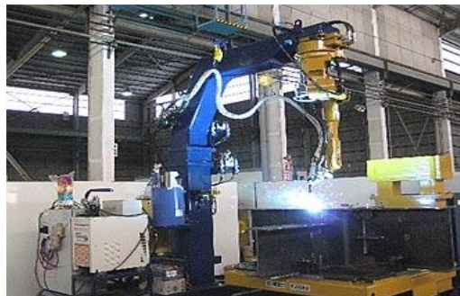
图 3 神户制钢所钢吊顶悬挂式倒车焊接机器人系统
