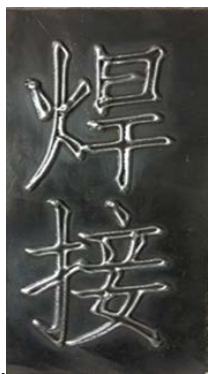
图4 “焊接”焊缝成形
