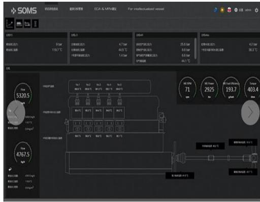
图 6 主机总体状态显示界面
