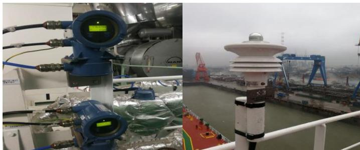
图 3 系统自动油耗流量计和气象站天线
